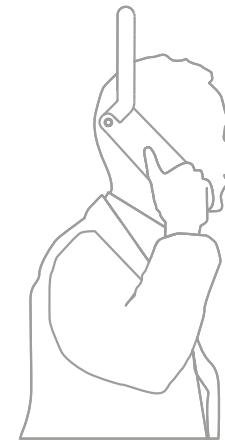
站在空旷无遮挡的室外，将电话天线向上竖起。电话的天线与卫星之间必须没有阻挡。
